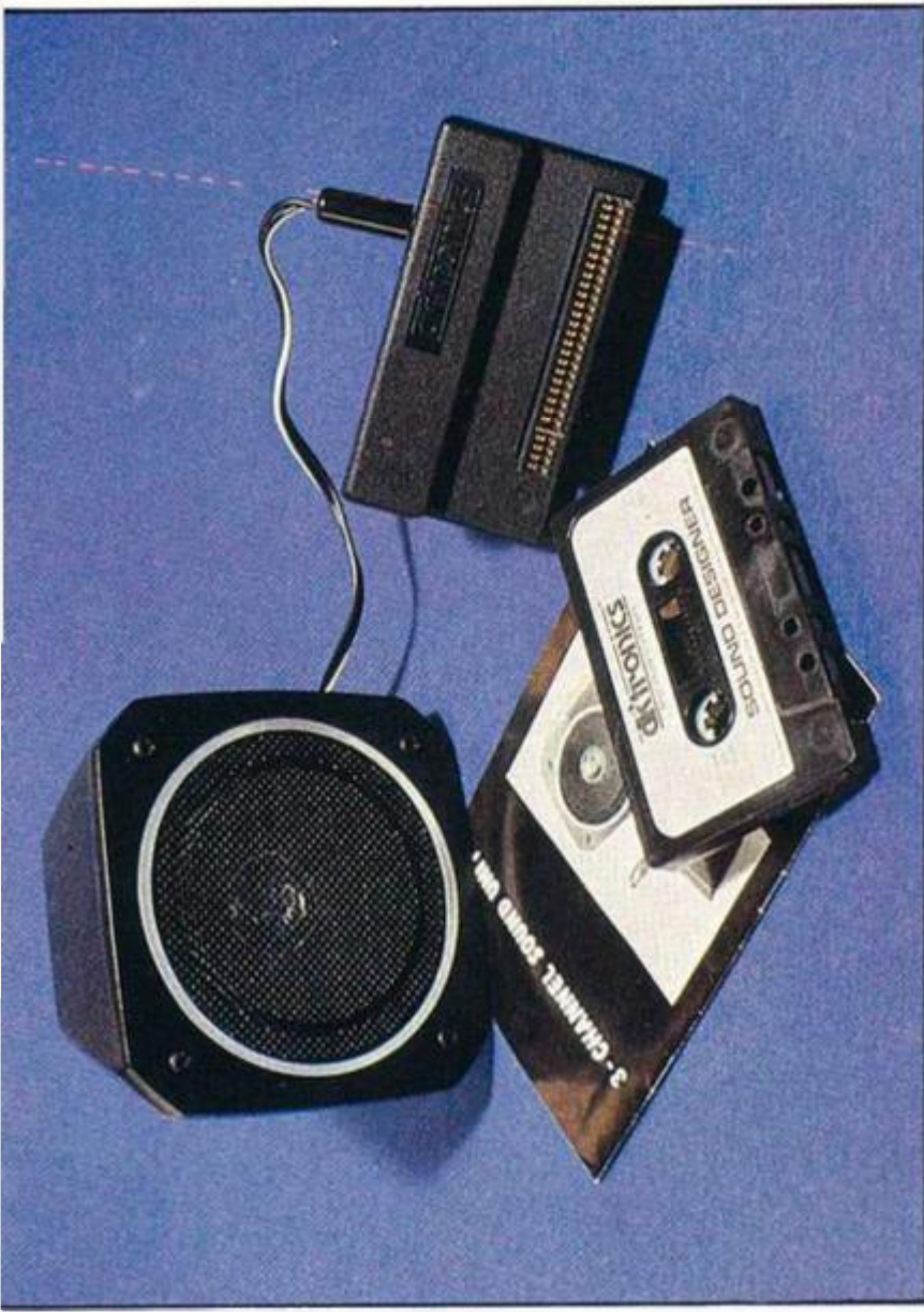
Las posibilidades sonoras del Spectrum quedan notablemente mejoradas con el uso de este sintetizador musical de tres canales.
