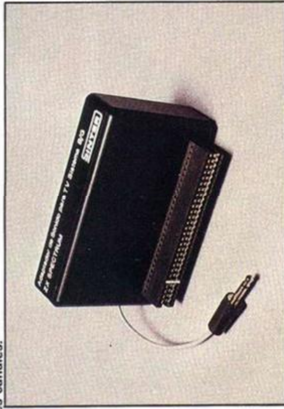
La señal de ancho del Spectrum puede mezclarse con la de video para ser reproducida simultáneamente en T.V.
